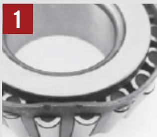
**Deformação do porta-rolos:** Instalação incorreta ou dano devido à queda.
