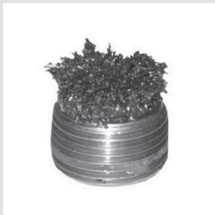
**Partículas de Metal Finas:** As partículas finas de metal presas ao bujão magnético na figura ao lado são normais. Os componentes internos podem lançar partículas de desgaste de metal finas em uma taxa constante, especialmente durante o período de amaciamento. Além dos bujões magnéticos, eixos também estão equipados com quatro a seis ímãs para capturar detritos gerados durante intervalos estendidos de manutenção e troca do lubrificante utilizados hoje em dia e informados no manual do veículo.
