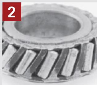
**Travamento e inclinação dos rolos:** Compressão do anel do porta-rolos na instalação ou interferência durante o funcionamento, ocasionando derrapagem (SKIDDING) por montagem errada ou desalinhada, folga ou pré-carga fora dos padrões.
