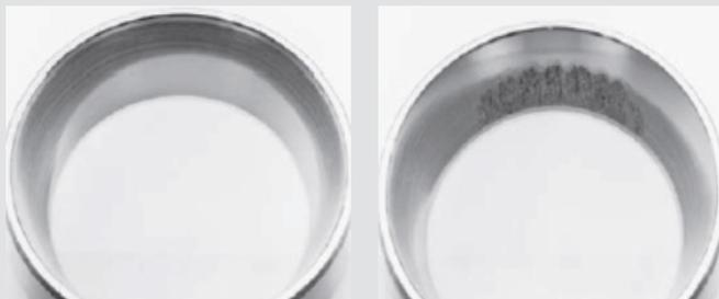
Irregularidade na pista do rolamento devido à deflexão, usinagem defeituosa, desgaste dos assentos dos rolamentos ou montagem desalinhada, concentrando a carga mais dos lados do rolamento. Podem estar descasados, lotes e marcas diferentes.
