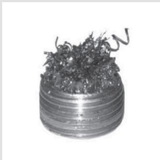
A figura ao lado mostra fragmentos de metal que são remanescentes do processo de usinagem de carcaça. Os fragmentos de metal aderem aos magnetos e não são prejudiciais para o funcionamento do eixo. Não é necessário realizar mais inspeções ou retirar o diferencial para limpeza.
