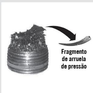
A perda de um fragmento da arruela de encosto não é prejudicial para o funcionamento do eixo e não requer a desmontagem, inspeção e substituição da arruela. Se você está preocupado com fragmentos adicionais ou danos aos componentes, realize uma análise da amostra de óleo. Se o teor de ferro da amostra está acima de 1000 partes por milhão (ppm), inspecione e repare o diferencial, se necessário. A figura ao lado mostra fragmentos da arruela de encosto do planetário do diferencial principal.
